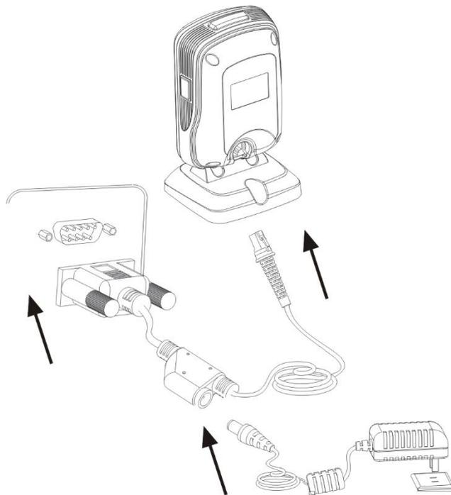
1. 将 RS-232 数据线的设备接口端（RJ 48 接口）与扫描器相连；
