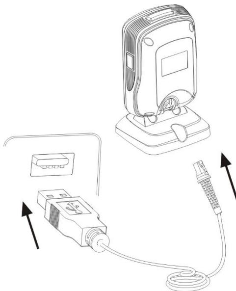
1. 将 USB 数据线的设备接口端（RJ48 接口）与扫描器相连；
